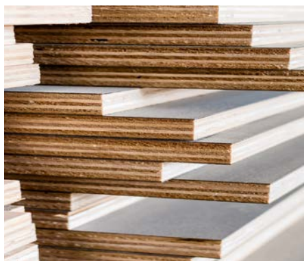
Fot. 10. Sklejka szalunkowa topolowa przeznaczona do docinania
