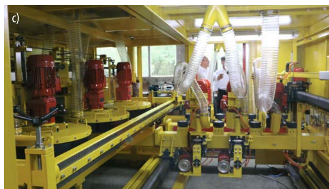
Fot. 13. Maszyna do czyszczenia płyt ściennych: a) podajnik płyt, b) widok ogólny, c) wnętrze maszyny
