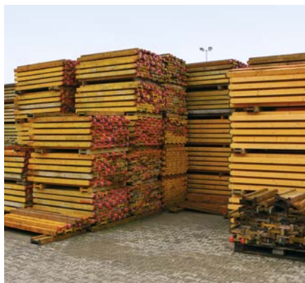
Fot. 4. Dźwigary systemu stropowego
