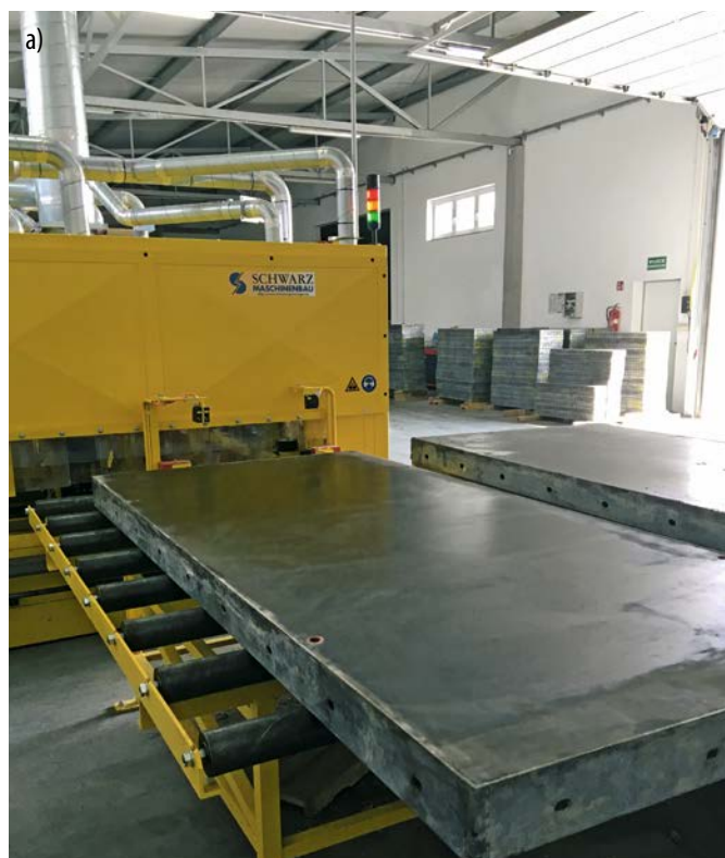
Fot. 13. Maszyna do czyszczenia płyt ściennych: a) podajnik płyt, b) widok ogólny, c) wnętrze maszyny
